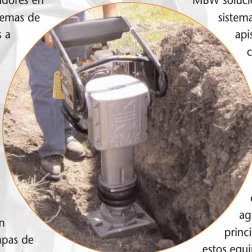
MBW soluciona problemas de mantenimiento en los sistemas de aceleración, zapatas de apisonamiento, tanques de combustible, cajas de engranajes, monturas de amortiguadores, rpm adecuadas del motor y respondemos la pregunta sobre cuándo el personal de servicio debe realizar las tareas de mantenimiento de rutina.
